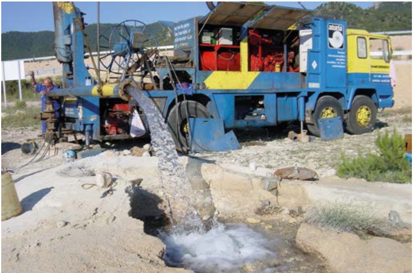
Equipo de ensayo de bombeo compuesto con un camión por grupo electrógeno, grúa y tubo pitot, para medida de caudales, y sondas de control piezométrico. Autor: Juan José Rodes Martínez.
