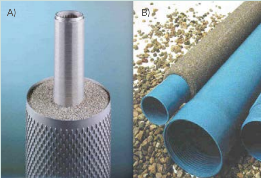
Figura 7.4.10. A) Rejilla doble, de apertura continua en el interior y de puentecillo en el exterior, con macizo de grava incorporado. B) Rejilla de PVC con macizo de grava pegado con resina a una rejilla ranurada.
