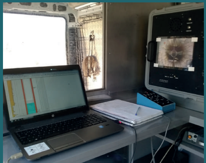
Sala de telecontrol de un equipo de diagraffas. Fuente: AQUATEC.
