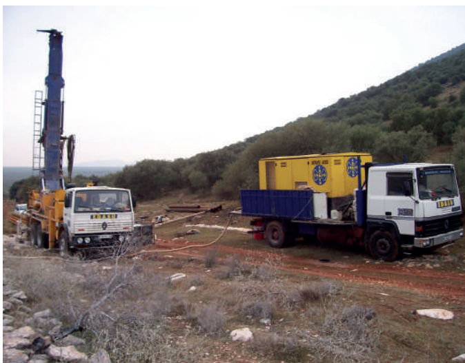
Equipo de rotopercusión directa (Sierra de La Algaidilla, Sevilla). Autor: Sergio Martos-Rosillo
