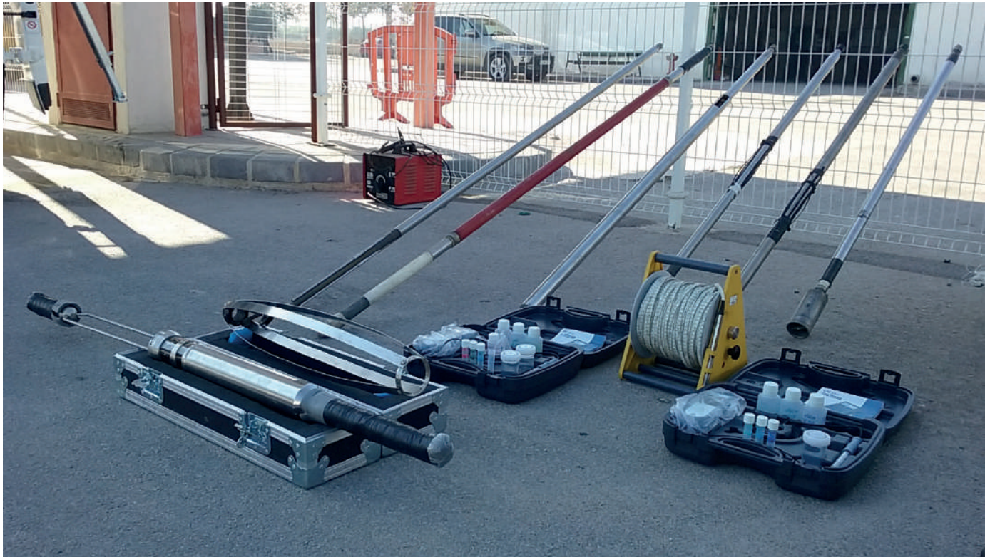
Diferentes sondas y cámara de video para sondeos. Fuente: AQUATEC.
