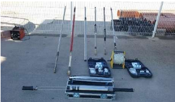
Figura 12. Equipo de inspección videográfica y testificación de sondeos.
