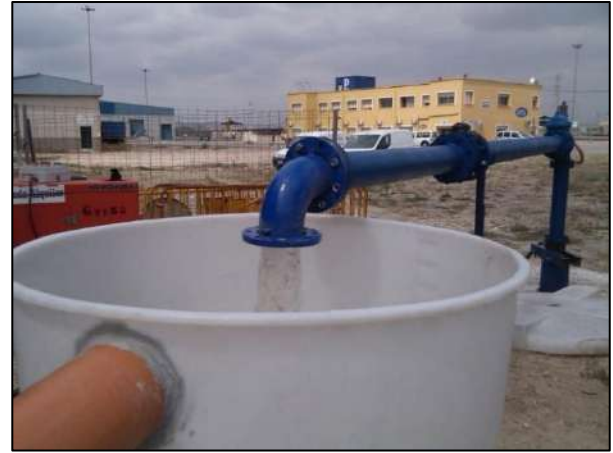
Figura 11. Ensayo de bombeo.
