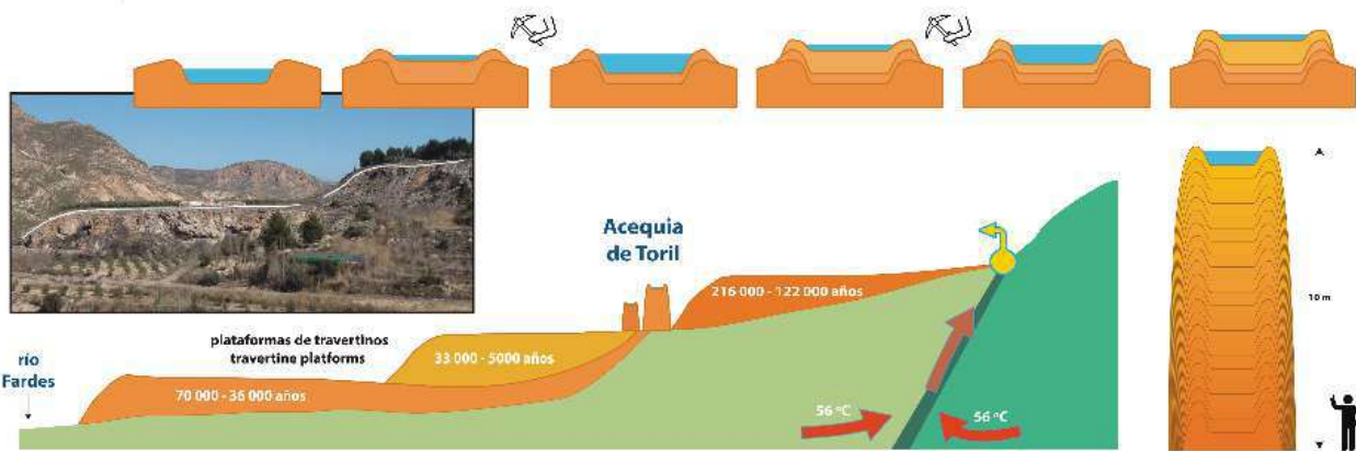
Figura 11. Modelo de crecimiento de precipitados de carbonato cálcico en el Acueducto del Toril y en las plataformas de travertinos asociadas a los Baños de Alicún.
