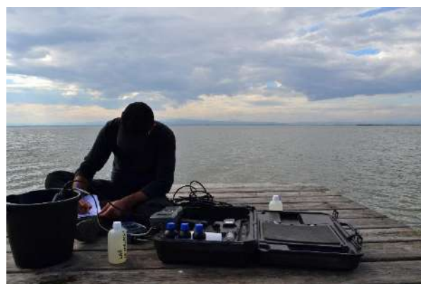
Foto 22: Toma de muestra de agua en la Albufera de Valencia (embarcadero de la gola de Pujol) y medida de parámetros "in situ" (temperatura, pH y conductividad eléctrica).
