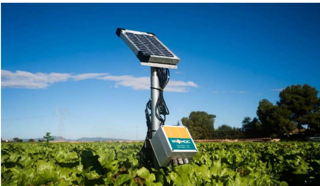
Figura 16. Muestra de sistema de control de la humedad en el suelo
