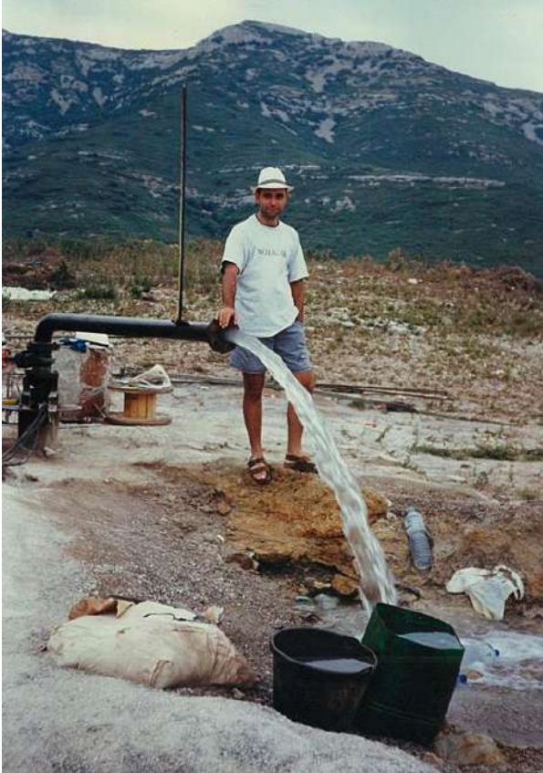
Foto 12: Ensayo de bombeo o prueba de aforo.
