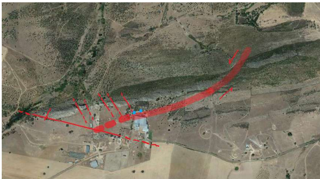
Figura 7.- Fallas (líneas rojas) y zona de cizalla (banda roja)
