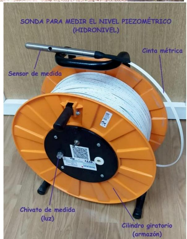
Figura 37: Sonda para medir el nivel piezométrico.
