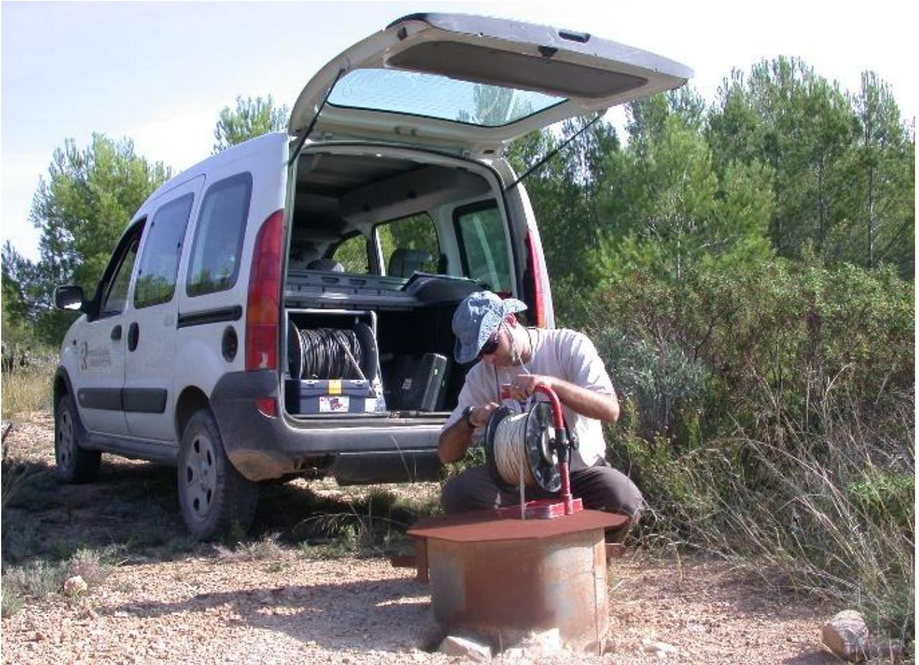
Figura 36: Medida del nivel piezométrico mediante sonda.
