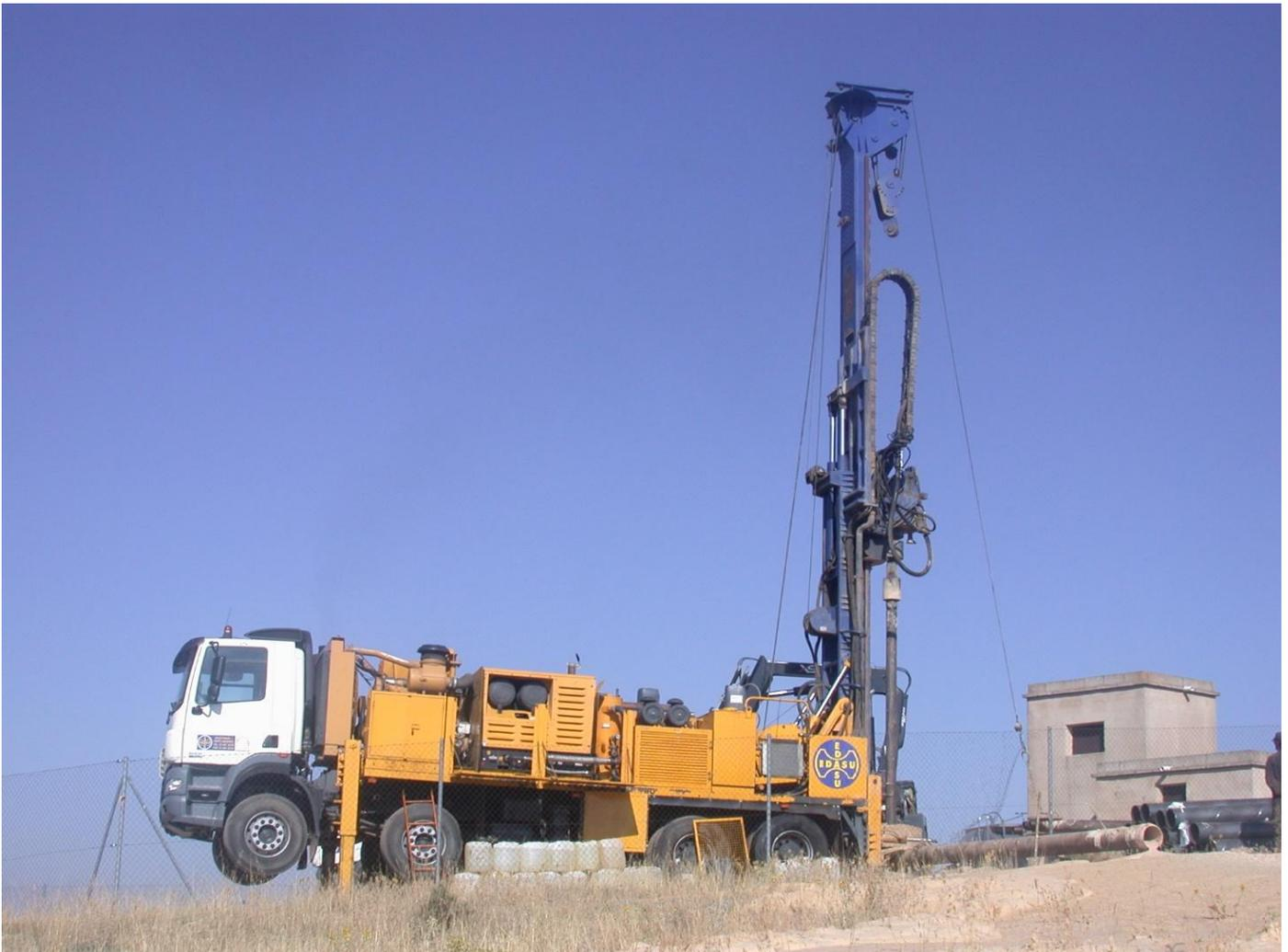
Figura 17: Perforación de un sondeo a rotopercusión
