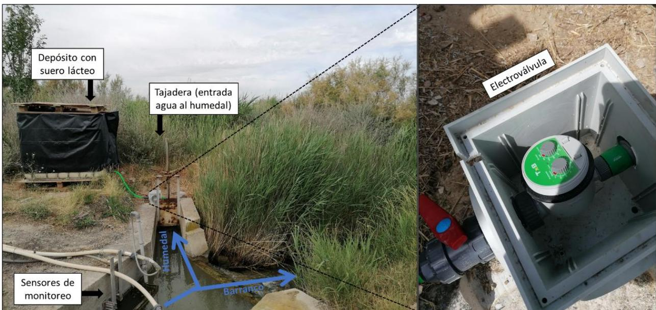
Figura 9. Imagen del sistema para la bioestimulación con suero lácteo (2025). El suero lácteo (donador de electrones para inducir la desnitrificación) derivado de la producción de quesos se acumula en un depósito. Mediante una electroválvula programable se inyecta la cantidad deseada y con la periodicidad deseada. La tajadera de entrada de agua al humedal permite regular el caudal. Los sensores de monitoreo permiten registrar datos en continuo de la calidad del agua (telemida).
