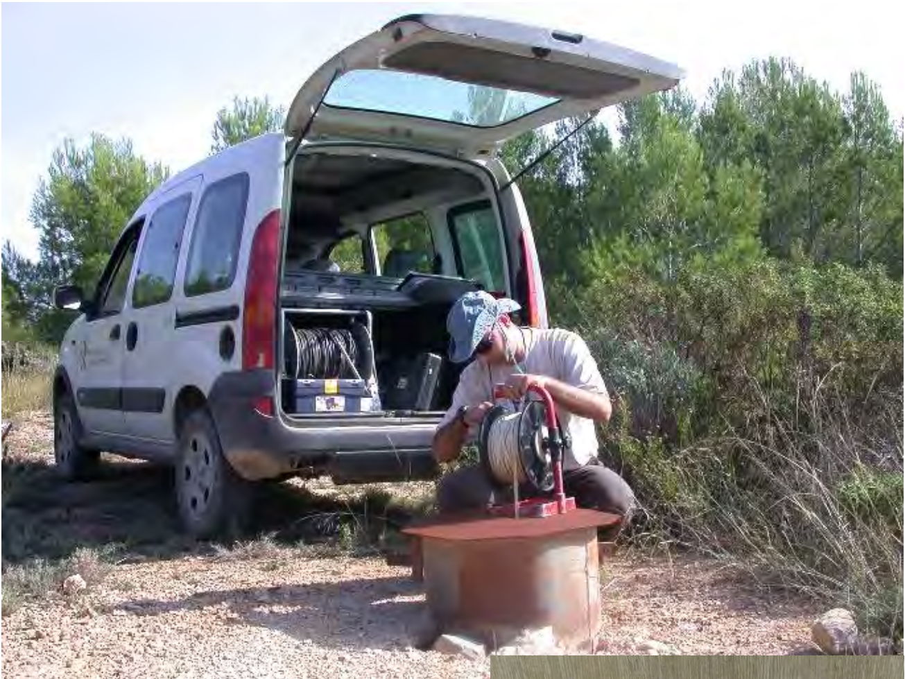
Foto 24: Medida del nivel piezométrico mediante sonda.
