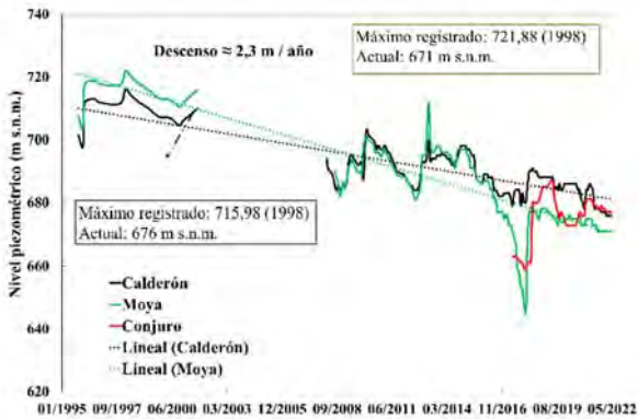
Figura 8: Evolución temporal de la cota piezométrica en tres sondeos representativos del acuífero de la sierra de Archidona. La ubicación puede observarse en la figura 1
