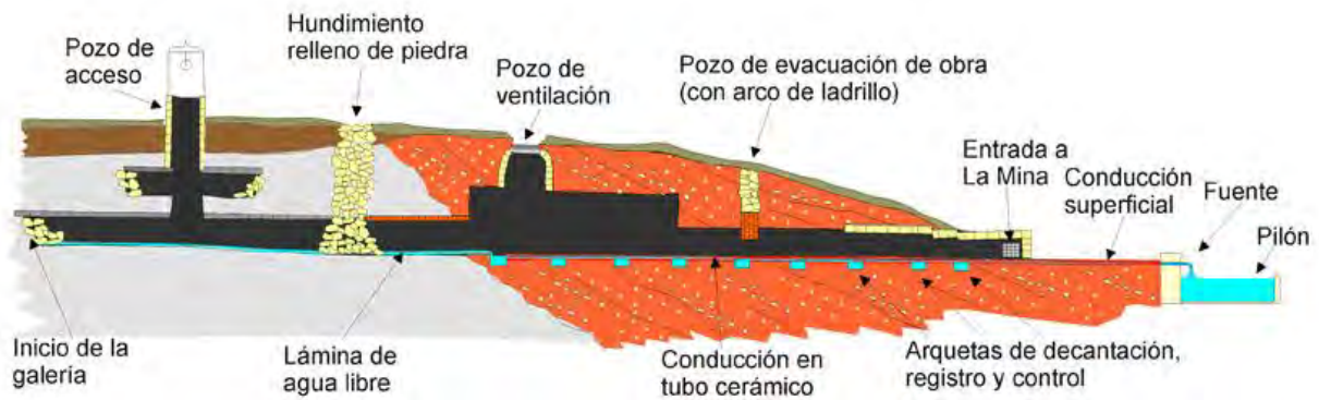
Figura 8 - Corte geológico idealizado de detalle de los elementos de La Mina de Carbonero el Mayor. Fuente: Díez-Herrero (2006).
