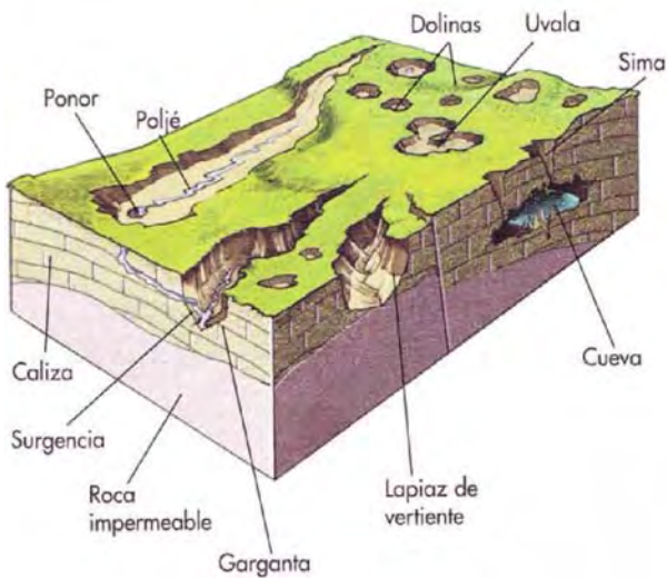
Figura 4: Bloque diagrama de un acuífero kárstico con las formas de disolución exokársticas y endokársticas más características
