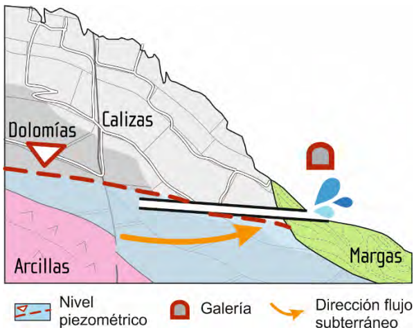
Figura 6: Representación esquemática del diseño y funcionamiento de una galería de captación de agua subterránea
