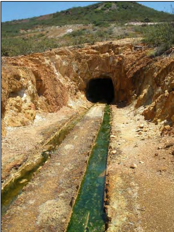
Figura 5. Fotografía de la Galería de La Sabina, situada al suroeste de Filón Sur. De esta galería mana un agua ácida de color verdoso debido a las condiciones reductoras, pero que rápidamente cambia en contacto con la atmósfera y se vuelve de color rojo intenso.
