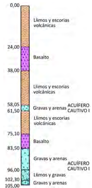
Figura 13. Columna litológica del pozo experimental para el abastecimiento de agua a Olot, modificado de Fayas y Domenech (1974).
