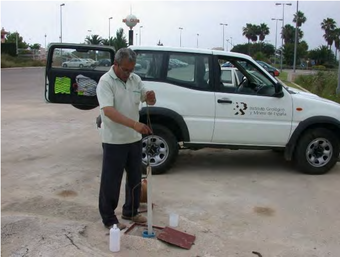
Foto 22: Toma de una muestra de agua subterránea en un piezómetro mediante tubo tomamuestras.
