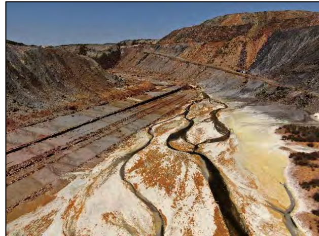
Figura 6. Izquierda: Suelos sobre los que se quemaban las teleras hasta finales del siglo XIX al sur del embalse Grande, más de 100 años después los niveles de contaminación siguen siendo tan altos que no puede crecer ninguna planta. Derecha: Restos de canales para la precipitación de Cu con chatarra de hierro al este de Filón Norte, se observan lixiviados ácidos y abundantes sales evaporíticas de colores blanquecinos y amarillentos.
