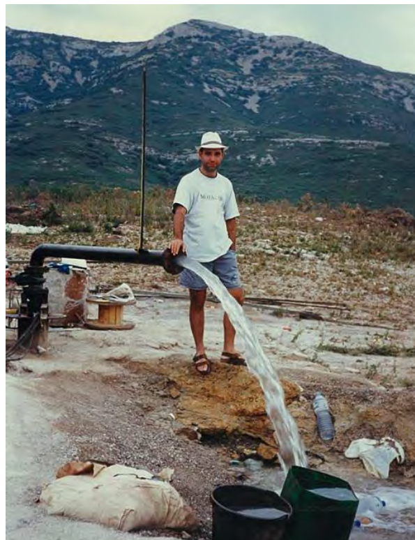
Foto 12: Ensayo de bombeo o prueba de aforo.
