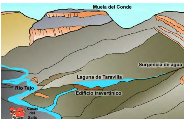
Esquema del sistema kárstico de la Laguna de Taravilla
