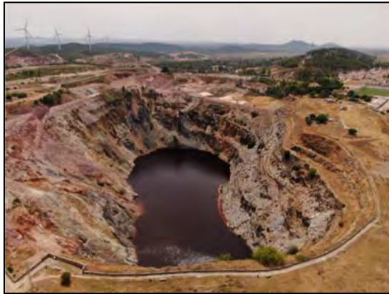
Figura 15. Fotografía de Sierra Bullones en el año 2020. El nivel del agua en esta corta y en Filón Norte aún no se ha estabilizado y continúa subiendo.
